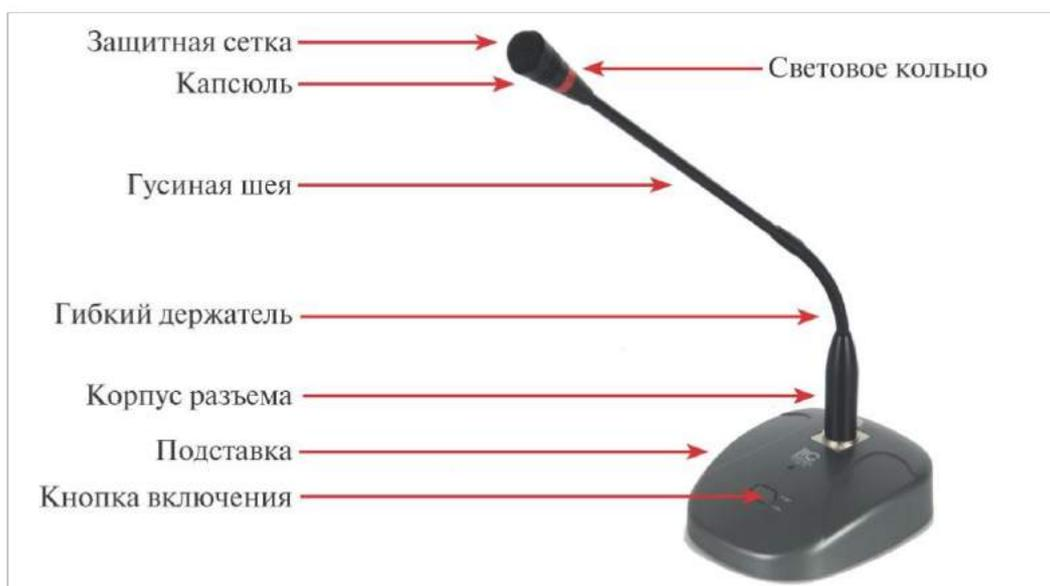
**Рис. 29.** Состав (конструктив) настольного микрофона ROXTON T-621
