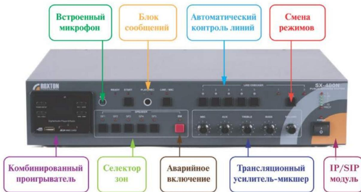
ROXTON SX-480N позволяет при помощи устройств, поддерживающих SIP-протокол (смартфон, планшет и т.п.) осуществлять трансляцию голосового сообщения по сети Ethernet, а также музыкальную трансляцию в стандарте «Интернет-радио».
