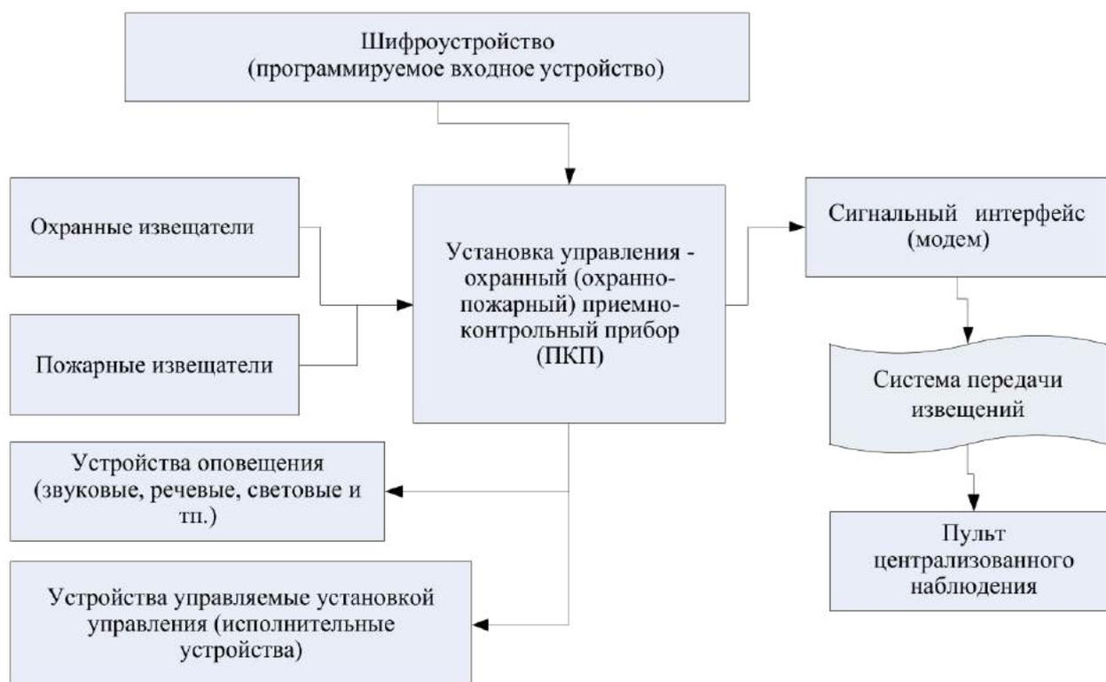
**Рис. 3.** Общая структура автоматической пожарной сигнализации
