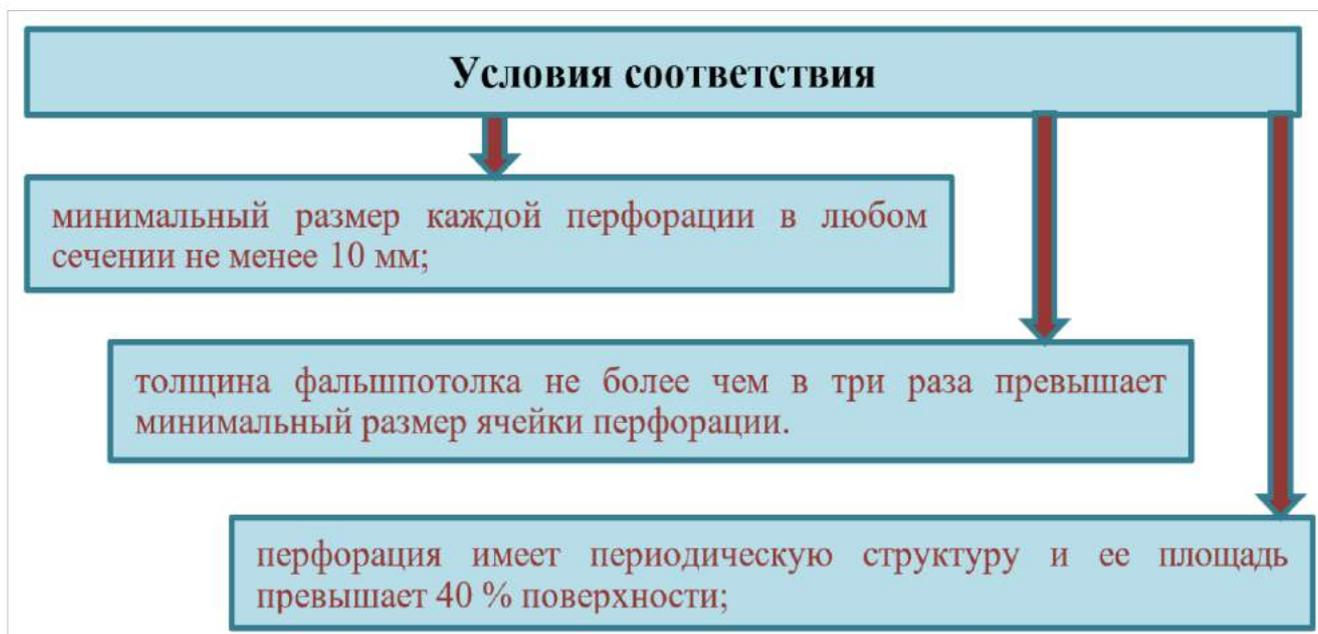
**Рис. 19.** Условия соответствия, при которых допускается защищать пространство извещателем ниже фальшпотолка
